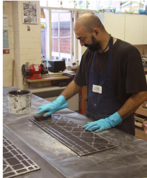
Fig. 1. Sistema tradicional de enmasillado de paneles emplomados mediante frotación de la masilla con cepillo. Foto: Michael Bullen/Dean and Chapter of Lincoln Cathedral.
