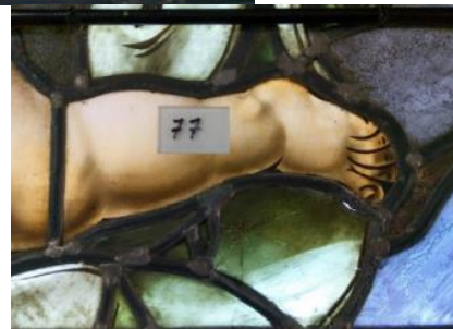
Fig. 39b. Reintegración cromática con Paraloid B72 y pigmento (reversible)
