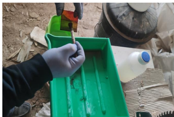
Fig. 8. Limpieza con ácido fluorhídrico de un vidrio con amarillo de plata que se ha metalizado. Por los vapores que se producen, yo acostumbro a realizar esta limpieza, si me es posible, al aire libre, con máscara específica y guantes que resistan el ácido, los hay especiales en cualquier centro de vestuario profesional.
