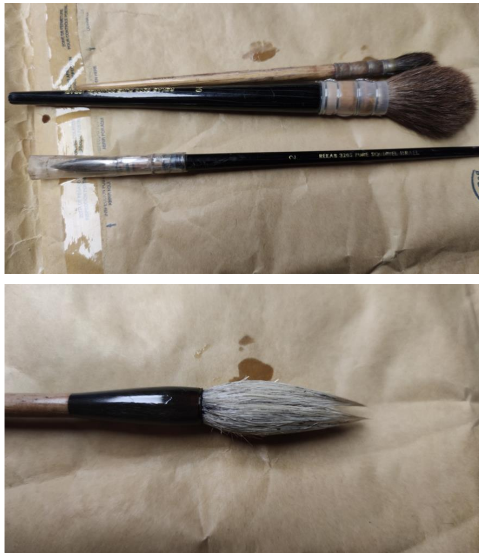
Fig. 5. En la foto superior varios pinceles de petigrís y pelo de marta que se adquieren ya con ese tipo de virola de plástico. El alambre con los que los venden, es normal, de acero galvanizado. Yo le pongo uno de plata y posteriormente quito el de acero. La foto inferior es un pincel de caligrafía japonesa con virola de asta. Para extender sobre el vidrio el amarillo de plata aconsejo adquirir las imitaciones chinas de estos caros pinceles japoneses --de cerdas sintéticas y virolas de plástico-- no así para pintar, ya que estos han de ser los de petigrís o marta o bien, para ciertas aguadas y medias tintas, van muy bien los de caligrafía japonesa.
