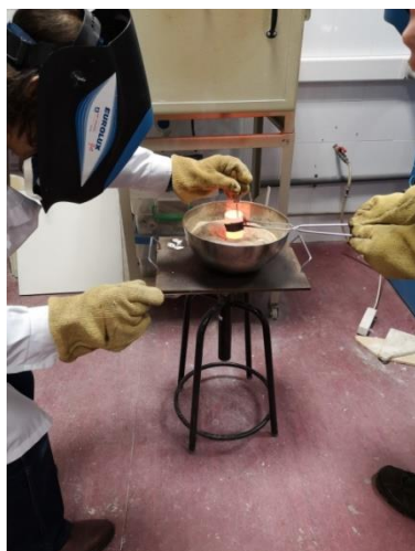
Mezclado de vidrio en caliente
