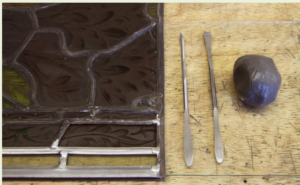
Fig. 13. Ejemplo de las herramientas utilizadas para la aplicación de la masilla en la red de plomo de forma manual. Foto: Fernando Cortés Pizano/ Dean and Chapter of Lincoln Cathedral .
