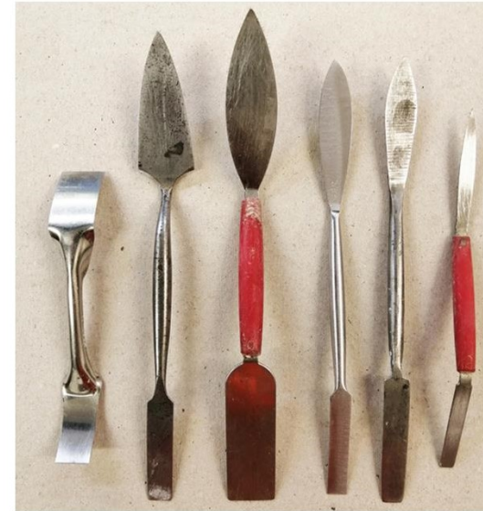
Fig. 7. Herramientas utilizadas para el trabajo de aplicación y texturizado del mortero en vidrieras: paletines y espátulas para rejuntar; brochas y paletinas para alisar, dar textura y limpiar; Imagen: Fernando Cortés Pizano.
