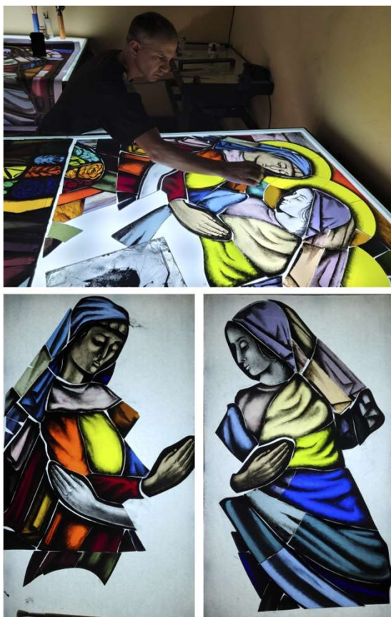
Fig. 16. Camagüey, Estudio - Taller Daluz. Aplicación de grisalla en el vitral de "La Visitación".
