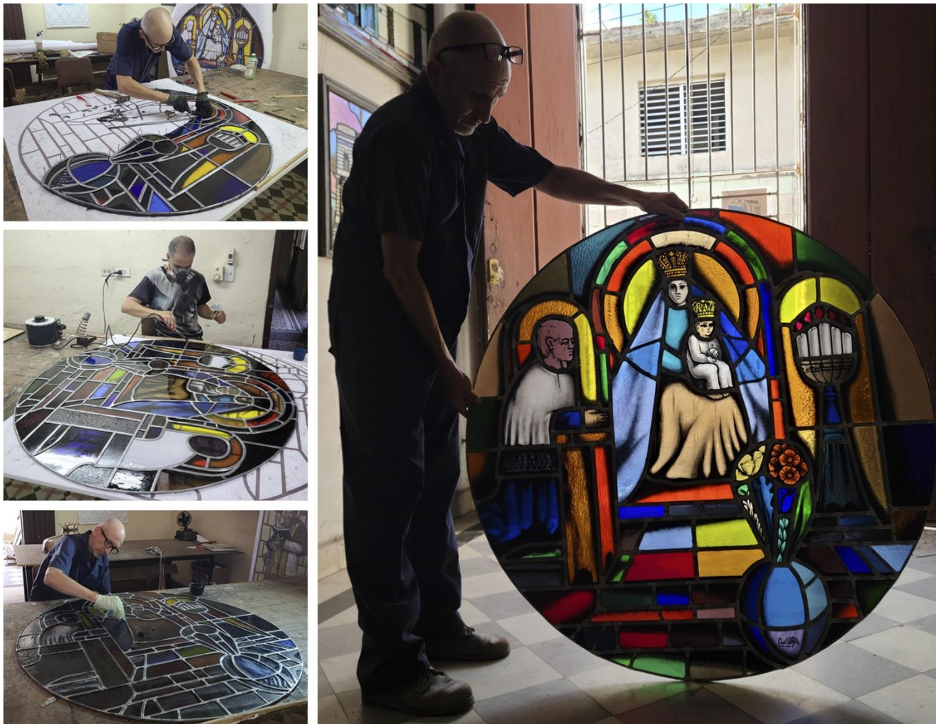
Fig. 13. Camagüey, Estudio - Taller Daluz. Armado de la red de plomo del vitral de la "Virgen de la Caridad del Cobre".
