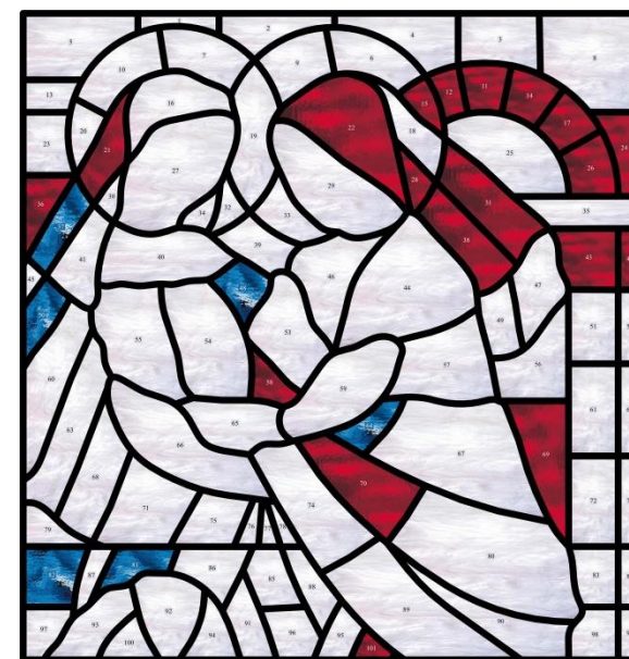
Fig. 15. Camagüey, Estudio - Taller Daluz. Esquema de clasificación de los vidrios del vitral "La Visitación a Isabel".
